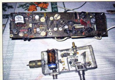
Obr. 14 a 15. S tímto vysílačem byly v sedmdesátých letech navázány stovky spojení v pásmu 70 a 23 cm. Vešel se do krabice od bot i se dvěma sadami napájecích baterií... Velmi zdařilá konstrukce
