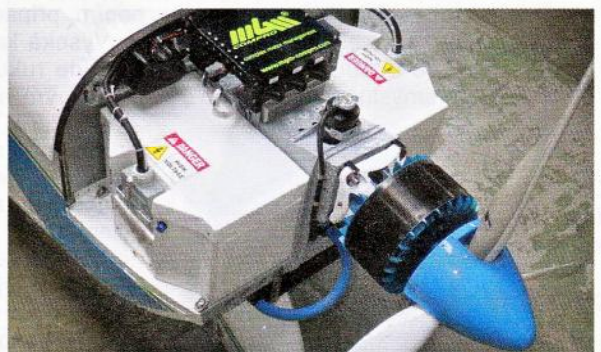
Obr. 4. Sportovní letadlo SportStar EPOS+ s elektrickým pohonem
