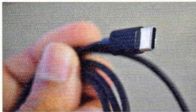
Konektor typu C je malý a oboustranný
