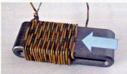
Obr. 126. Vinutí vně plochého toroidu má menší indukčnost (šipka představuje vnější magnetický tok), ale funguje jako anténa
