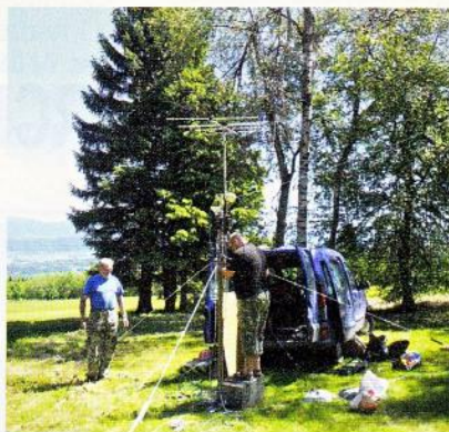
Obr. 3. KV PD 2014, stavba antén stanice OK1RCX/p na kótě Adam v Orlických horách (JO80HC). Vlevo OK1FRT, u stožárku OK1IN. Vysunovací 10m Al stožárke sloužil jako podpora drátových antén pro KV a zároveň nesl rotátor s Yagi anténou na 2 m, protože současně s KV PD probíhají také soutěže na VKV
