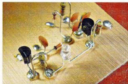
Obr. 129. Ukázka zapojení obvodu metodou „Manhattan“. Zemní konce součástek se pájejí na společnou plochu, ostatní na přilepené kuprexitové terčičky
