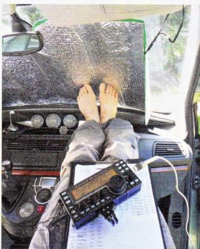
Obr. 2. Vysílací stanoviště při KV PD 2014 stanice OL0A/p, typ „pohoda“. RIG Elecraft KX3 napájený z baterie, výkon 5 W, papero-log
